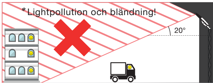
Armatur montage \geq 10^\circ i förhållande till marken. Lightpollution och bländning
